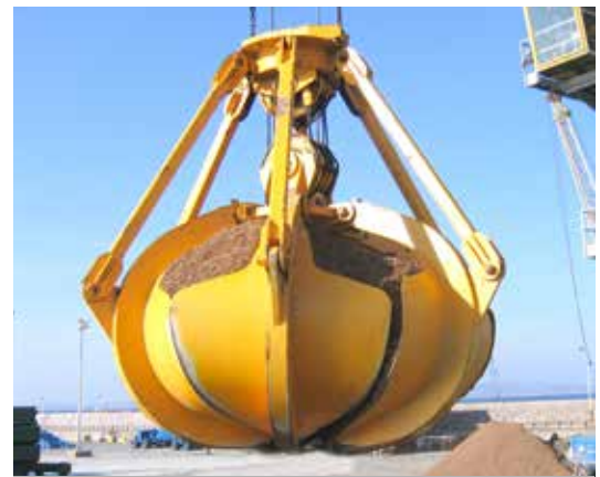
PEINER Vierseil-Mehrschalengreifer (VMG) beim Umschlag von Holzackschnitzeln PEINER Four-Rope Orange Peel Grab (VMG) handling woodchips
