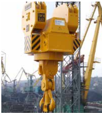
PEINER Schwenkwerk PEINER Slewing Unit
