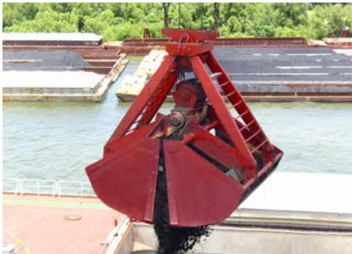
PEINER Vierseil-Zweischalen-Stangengreifer (VSG) beim Umschlag von Eisenerz PEINER Four-Rope Dual Scoop Grab (VSG) handling iron ore
