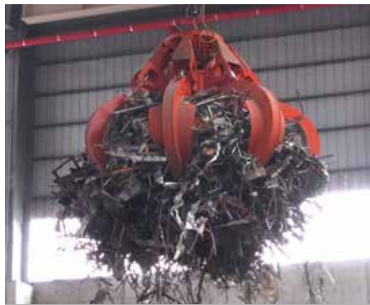
PEINER Motor-Mehrschalengreifer (MMG/MMGL) beim Umschlag von Schrott PEINER Motor Orange Peel Grab (MMG/MMGL) handling scrap
